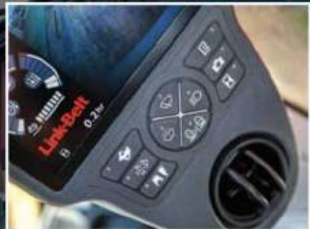
El monitor LCD de alta definición tiene una pantalla de 7 pul. a todo color similar a la resolución de los automóviles de lujo. Los controles son fáciles de leer y de usar. La cámara retrovisora se activa automáticamente cada vez que se arranca la máquina, y se han añadido pautas de visión para incrementar la seguridad.
